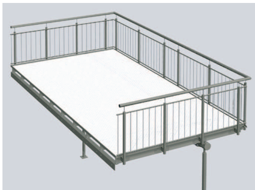
Abbildung: STEH-BALKON Auskrägung 2895mm Breite 5600mm Geländer Staketten Konstruktion Aluminium in Grau DB 703 pulverbeschichtet Unterspannung 3 Feld Balkonbelag Alu-Riffelblech Duett in "Weiß Marmor Feinstruktur" pulverbeschichtet.
