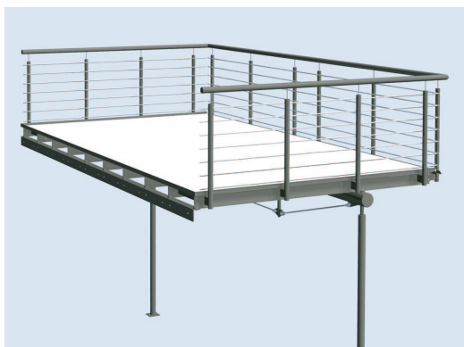
Abbildung: STEHBALKON Auskragung 2895mm Breite 5600mm Geländer Reling Konstruktion Aluminium in Grau DB 703 pulverbeschichtet Unterspannung 3 Feld Balkonbelag Alu-Riffelblech Duett in "Weiß Marmor Feinstruktur" pulverbeschichtet.
