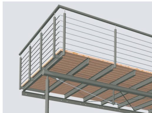
Abbildung: STEH-BALKON Auskragung 2895mm Breite 5600mm SB-AL-DGA 07-06 Geländer Reling Konstruktion Aluminium in Grau DB 703 pulverbeschichtet Unterspannung 3 Feld Balkonbelag Douglasie Dielen geölt.
