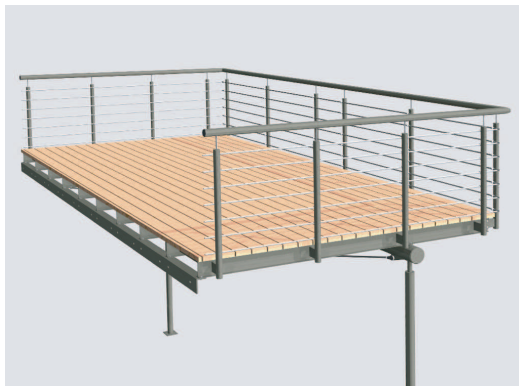
Abbildung: STEH-BALKON Auskragung 2895mm Breite 5600mm SB-AL-DGA 07-06 Geländer Reling Konstruktion Aluminium in Grau DB 703 pulverbeschichtet Unterspannung 3 Feld Balkonbelag Douglasie Dielen geölt.
