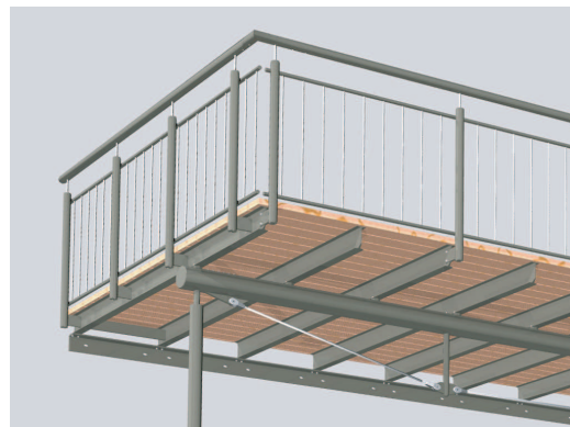
Abbildung: STEH-BALKON Auskrugung 2895mm Breite 5600mm SB-AL-DGA 07-06 Geländer Staketten Konstruktion Aluminium in Grau DB 703 pulverbeschichtet Unterspannung 3 Feld Balkonbelag Douglasie Dielen geölt.
