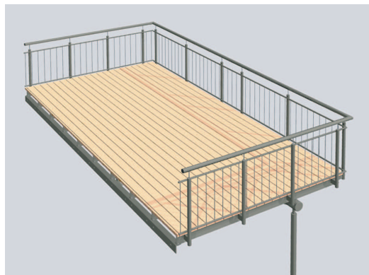
Abbildung: STEH-BALKON Auskrugung 2895mm Breite 5600mm SB-AL-DGA 07-06 Geländer Staketten Konstruktion Aluminium in Grau DB 703 pulverbeschichtet Unterspannung 3 Feld Balkonbelag Douglasie Dielen geölt.
